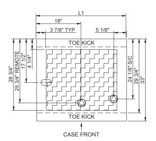
NOTE: SELF-CONTAINED REFRIGERATION CONNECTIONS ONLY ACCESSIBLE BY PULLING OUT CONDENSER DRAWER
