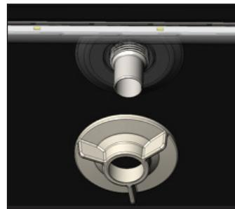
Fig. 2. Thread the spill tray tube nut.
