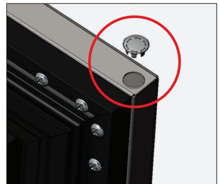
**Fig. 11.** Install the plug.
