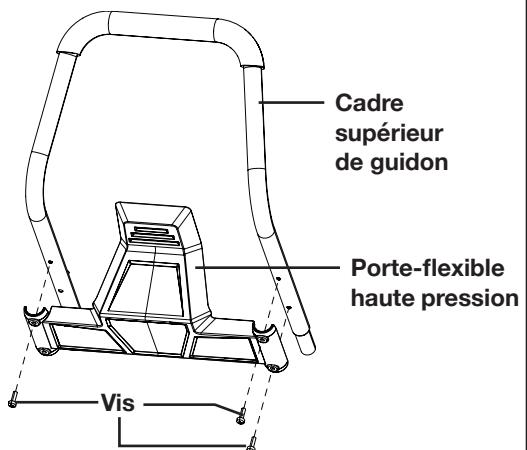
4. Attachez le porte-pistolet au cadre supérieur de guidon à l'aide de l'écrou et du boulon fournis, comme l'indique l'illustration. Serrez bien (Fig. 3).
