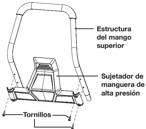
4. Conecte el sujetador de la pistola rociadora a la estructura del mango superior utilizando la tuerca y el perno incluidos, como se ilustra. Apriete firmemente. (Fig. 3).
