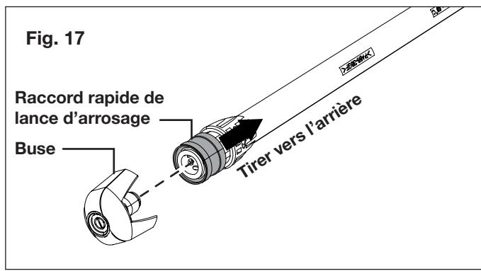
Pour débrancher la buse de la lance d'arrosage une fois que le nettoyage est achevé :
