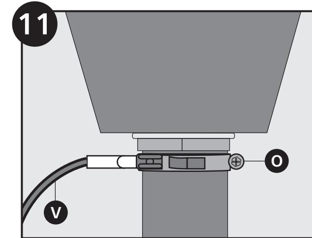
Connect the brass plated end (black sleeved) of the green Grounding Isolation Wires (V) to the drain ground clamp tab (O)./Conecte el extremo enchapado en bronce (con funda negra) de los cables de aislamiento de conexión a tierra verdes (V) a la lengüeta del sujetador con conexión a tierra de drenaje (O)./Connectez l'extrémité plaquée en laiton (avec gaine noire) des fils de mise à la terre (V) sur la patte pour collier de mise à la terre de vidange (O).
