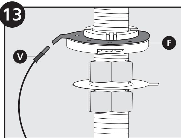
Connect the other end of the green Grounding Isolation Wires (V) to the tab grounding spacer (F)./Conecte el otro extremo de los cables de aislamiento de conexión a tierra verdes (V) al espaciador con conexión a tierra con lengüeta (F)./Connectez l'autre extrémité des fils de mise à la terre (V) à l'entretoise de mise à la terre de la patte (F).
