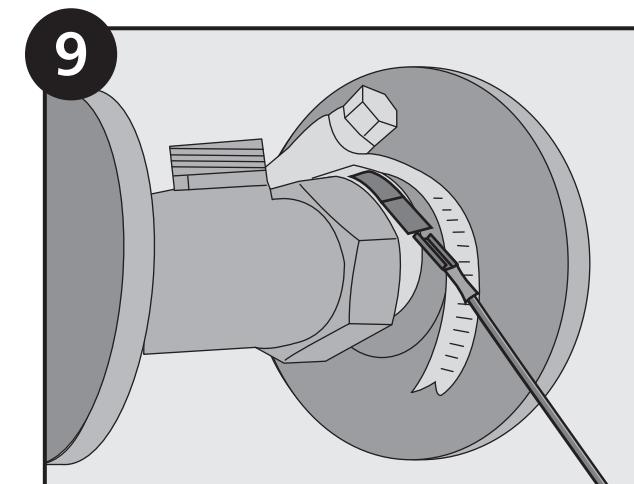
Connect the longer green earth ground wire to the clamp tab./Conecte el cable de conexión a tierra verde más largo a la lengüeta del sujetador./Connectez le long fil de mise à la terre vert sur la patte pour collier.
