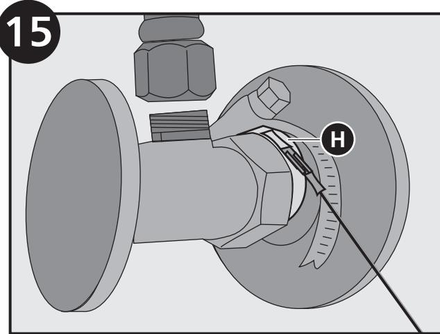
Connect the black sensor wire to the sensor washer (H)./Conecte el cable del sensor negro a la arandela del sensor (H)./Connectez le fil du capteur noir à la rondelle du capteur (H).
