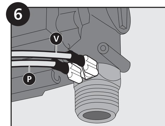
Connect the earth ground wire (P) to one side of the U-tab. Then connect the yellow sleeved drain ground connector, located on the Grounding Isolation Wires (V), to the other side of the brass U-tab./Conecte el cable de conexión a tierra verde más largo a la lengüeta del sujetador./Connectez le long fil de mise à la terre vert sur la patte pour collier.
