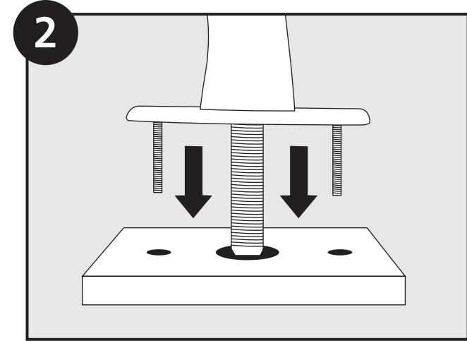
Guide the semi-assembled faucet spout through the 3-hole 4" or 8" center set in counter or sink./Guíe el pico del grifo semiensamblado a través del centro con 3 orificios de 10,16 (4 in) u 20,32 cm (8 in) en la mesada o el lavamanos./Orientez le bec de robinet semi-assemblé vers l'entraxe de 10,2 ou 20,4 cm à trois trous du comptoir ou lavabo.
