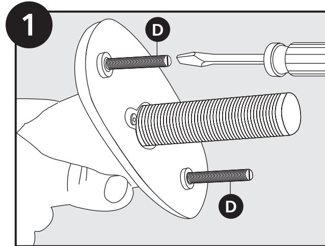
Attach both threaded studs (D) to the bottom of the semi-assembled cover plate./Anexe ambos pernos roscados (D) a la parte inferior de la placa de recubrimiento semiensamblada./Fixez les deux goujons filetés (D) au bas de la plaque-couvercle semi-assemblée.
