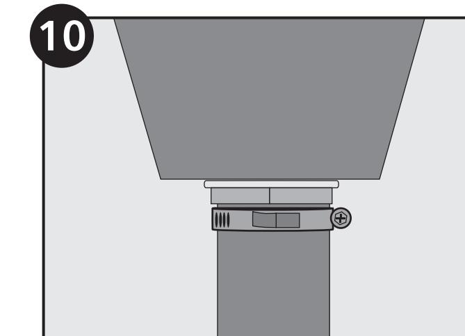
Mount the drain ground clamp to the metal drain tail stock as close to the sink as possible./Coloque el sujetador con conexión a tierra de drenaje en el cabezal móvil de drenaje metálico lo más cerca del lavamanos posible./Montez le collier de mise à la terre de vidange sur la contre-poupée de vidange métallique aussi proche du lavabo que possible.
