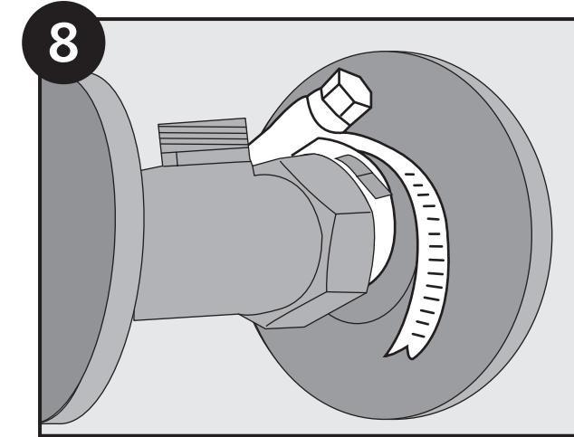
Mount the earth ground clamp to the cold water supply pipe./Coloque el sujetador con conexión a tierra en la tubería de suministro de agua fría./Montez le collier de mise à la terre sur le tuyau d'alimentación en eau froide.
