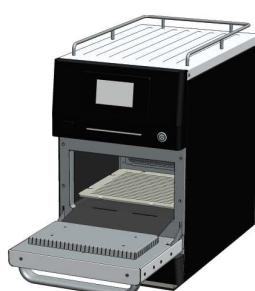
**4- REINSTALL THE SPEED GRILL IN THE EQUIPMENT TO COMPLETE THE ASSEMBLY.**
