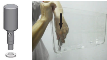
Disposer le joint torique sur la vanne du distributeur (vérifier qu'il n'est pas endommagé ou déformé). Mettre la vanne dans le bac.
