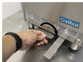
Sortir les supports de fixation du bac d'égouttage.
