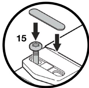
15. Insérer les boulons d'arrêt. Aligner la porte latéralement et bien resserrer les boulons d'arrêt.
