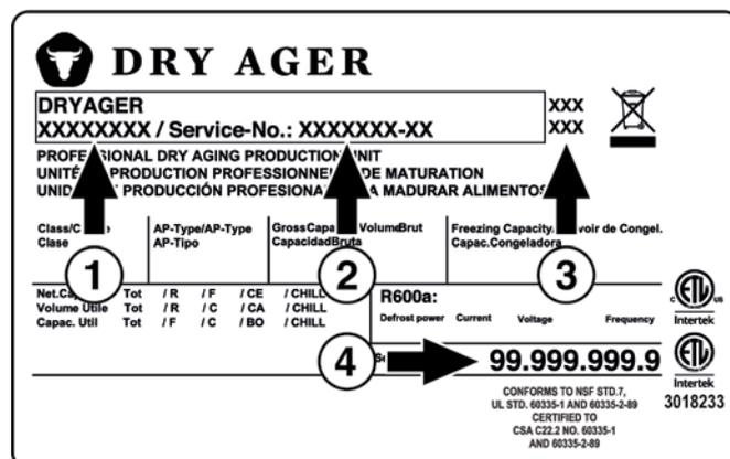
Lorsque vous contactez le service client (les coordonnées se trouvent au dos de ce manuel), veuillez préciser la désignation du type ①, le numéro d'identification ②, le suffixe du numéro d'identification ③ et le numéro de série ④ tels qu'indiqués sur l'étiquette signalétique. L'emplacement de l'étiquette signalétique est indiqué dans la section **Description de l'appareil** (page 23).
