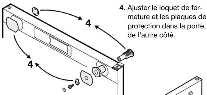
4. Ajuster le loquet de fermeture et les plaques de protection dans la porte, de l'autre côté.
