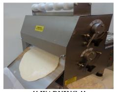
!! WARNING !! <u>IF THE DOUGH GETS STUCK IN THE CHUTE,</u> <u>NEVER ATTEMPT TO MOVE THE DOUGH BY HAND WHILE THE</u> <u>MACHINE IS RUNNING.</u>
