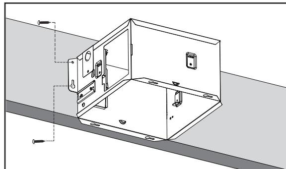
2. Support avec trous de fixation et barre de suspension.
