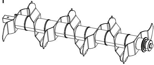
Cilindro escarificador con cuchillas
