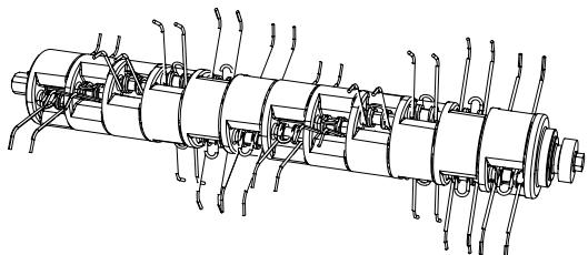
Cilindro rastrillador (aireador) con púas metálicas flexibles
